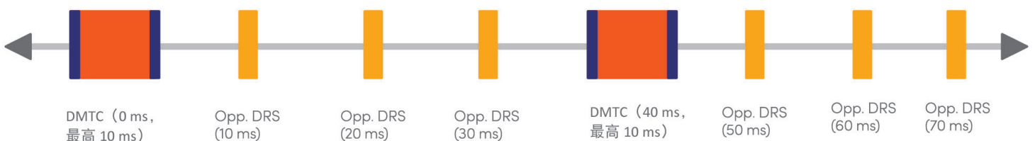
图 11. 通过 PBCH 进行 DRS 及 SFN 指示的 DMTC 和机会传输
